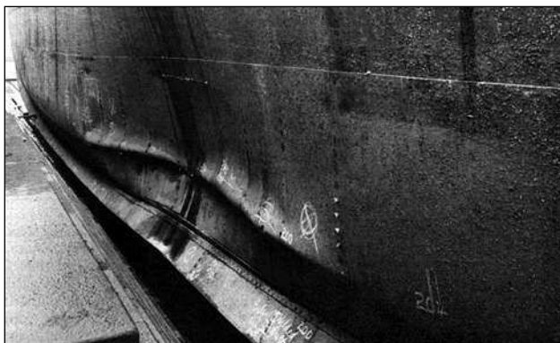
Повреждения обшивки корпуса «Принс оф Уэльса» в результате близкого разрыва бомбы в августе 1940 г.
