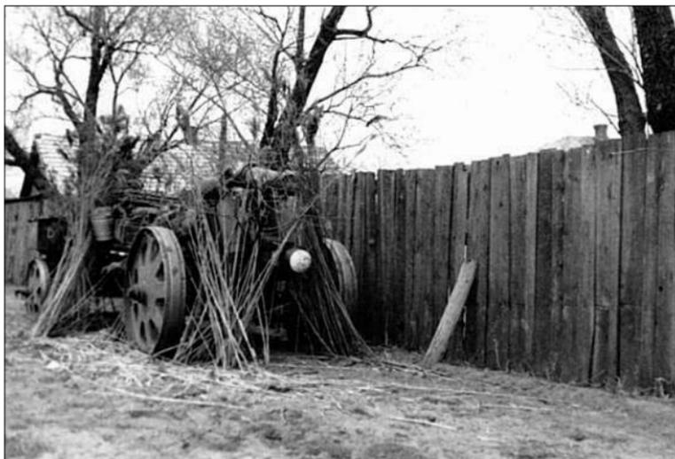
Одна из четырех 15-см гаубиц 10-й батареи — минус ствол — ждет своего часа вступить в дело. Ей недолго ждать. Тяжелые орудия часто разбирали для долгих маршей, чтобы снизить нагрузку на лошадей. Ствол ехал в отдельной повозке
