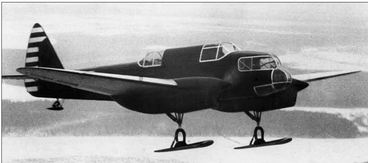
УТ-3 на лыжном шасси в ходе заводских испытаний
