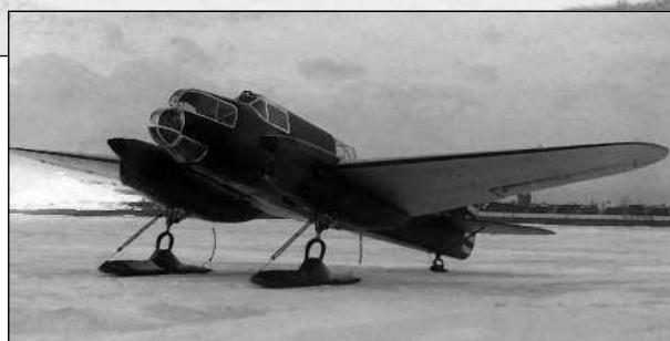
УТ-3 на лыжном шасси в ходе заводских испытаний
