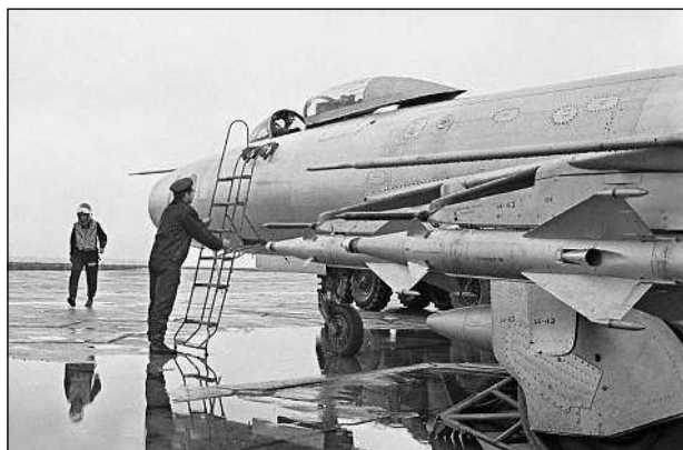
Перехватчик Су-9 оснащался только реактивным управляемым вооружением, включавшим в себя четыре ракеты РС-2УС, наводимые на цель при помощи РЛС ЦД-30
