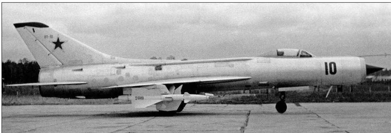
Авиационный комплекс перехвата Су-11-8М включал в себя истребитель Су-11, оснащенный более мощной РЛС «Орел», и самонаводящиеся ракеты К-8М
