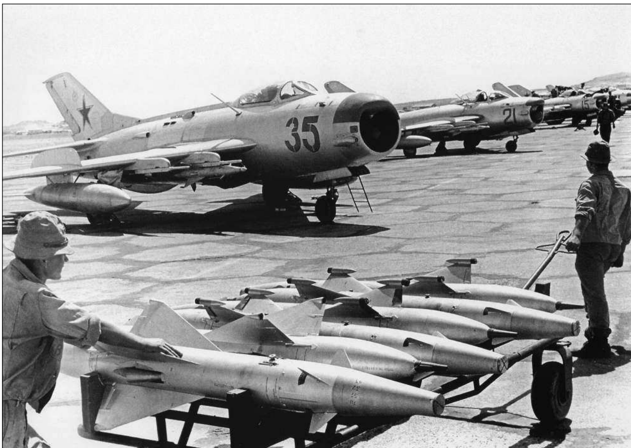
С середины 50-х годов истребительная авиация стала пополняться сверхзвуковыми перехватчиками МиГ-19ПМ, оснащенными радиолокационным прицелом «Изумруд» и ракетным вооружением
