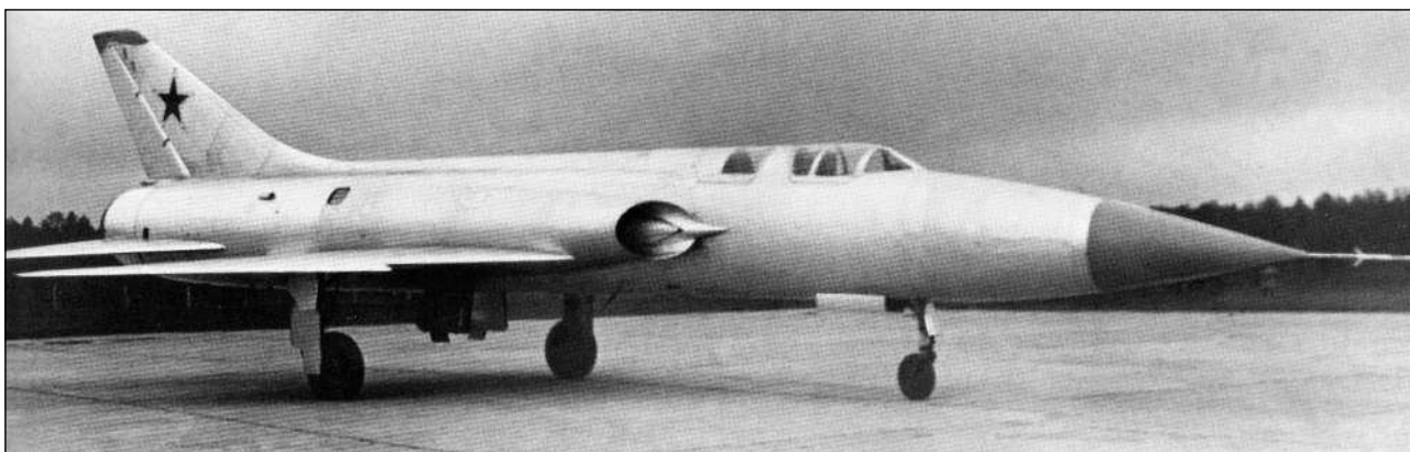
Опытный истребитель-перехватчик П-1 в серии предполагалось оснастить мощнейшим двигателем Р15-300
