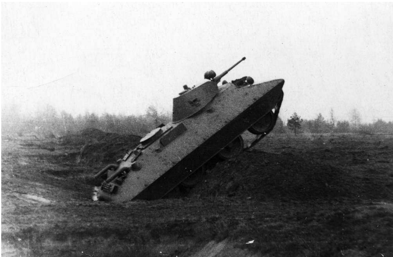
Танк БТ-СВ-2 спроектированный Н. Цыгановым, на испытаниях. 1939 год. На этой машине, создававшейся параллельно с А-20, отработывалась схема бронекорпуса с наклонным расположением листов (АСКМ).
