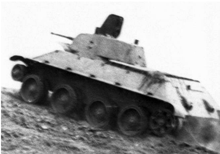
Танк А-20 преодолевает подъем на колесном ходу, 1939 год (АСКМ).
