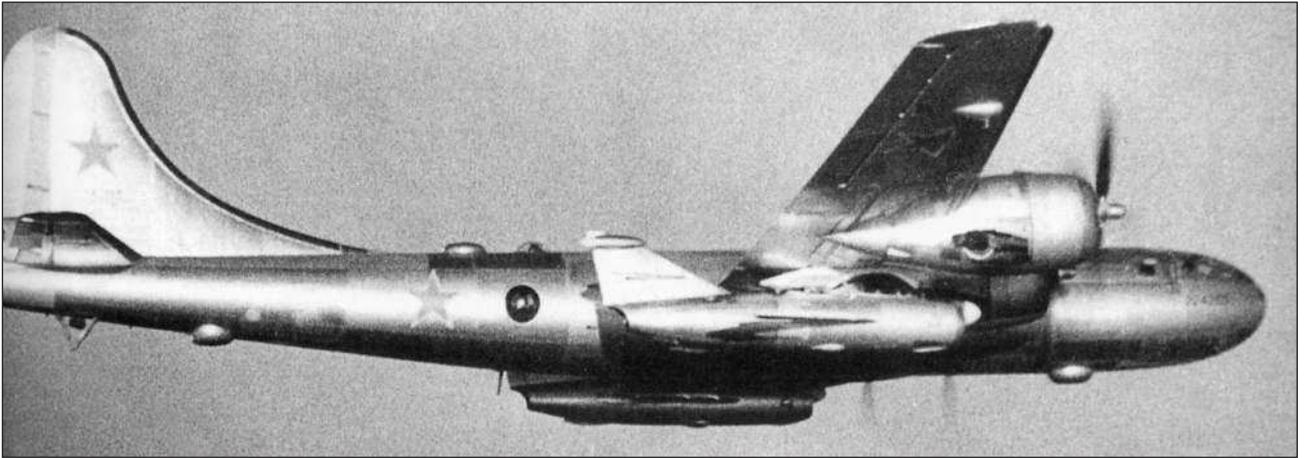
Опытный носитель Ту-4К № 224203 с двумя самолетами-аналогами под крылом
