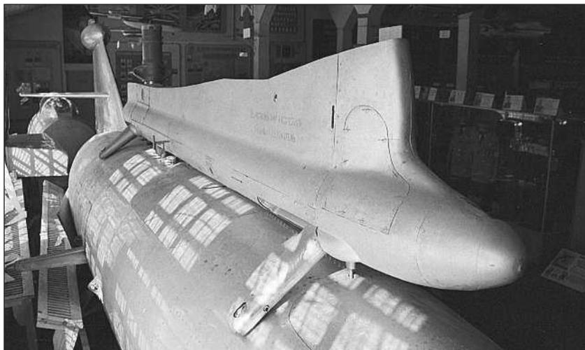
**Балочный держатель БД-187, предназначавшийся для подвески самолета-снаряда КС-1 под ракетоносец Ту-16КС. Хорошо видны массивные ухваты, препятствующие поперечной раскачки подвешенного изделия**
