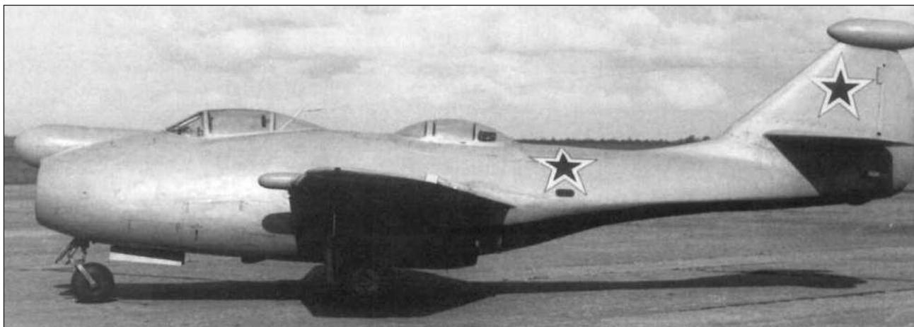
Двухместная летающая лаборатория МиГ-9Л («ФК») для испытаний аппаратуры наведения «К-1» самолета-снаряда «Комета»
