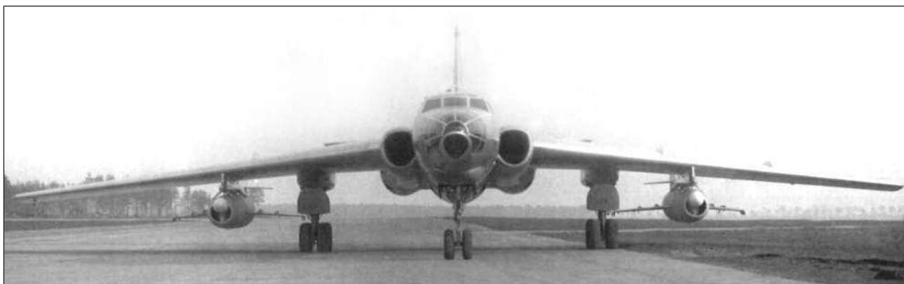
Первый опытный ракетоносец Ту-16КС № 4200305 с подвесками самолетов-снарядов КС-1 системы «Комета»
