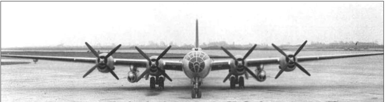
Серийный Ту-4К с двумя самолетами-снарядами КС-1 под крылом
