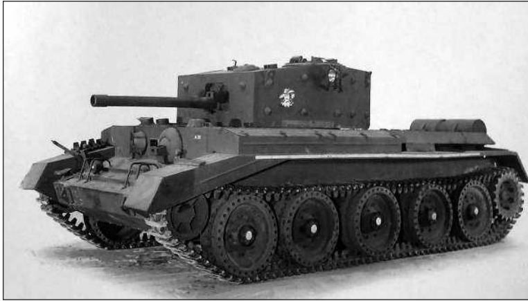
Один из трех прототипов танка Mk. VII A24 Cavalier Mk. I произведенный в январе 1942 г.
