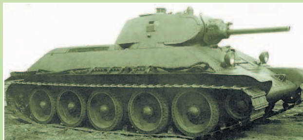
Серийный танк Т-34 выпуска 1940 года с 76-мм пушкой Л-11
