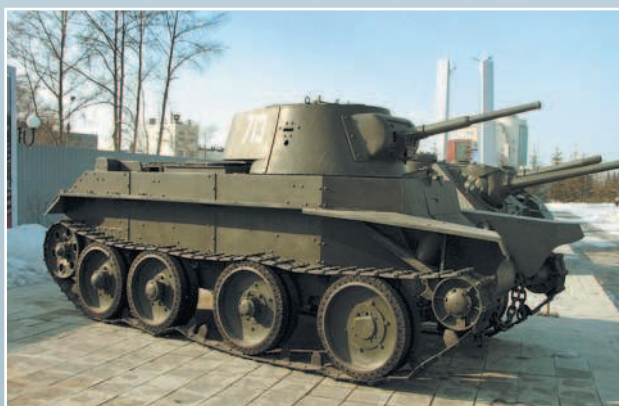
Колесно-гусеничный танк БТ-7 – типичный представитель класса «легких-средних» танков
