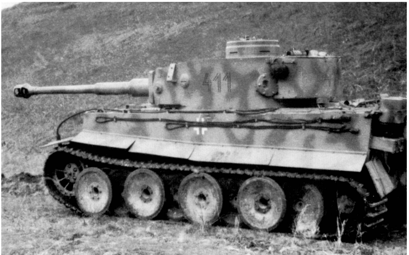
Танк «Тигр» роты тяжелых танков 1-й панцергренадерской дивизии СС «Лейбштандарт Адольф Гитлер». Район Белгорода, май 1943 года. Машина имеет башенный номер 411, хорошо виден двухцветный камуфляж, а также укладка троса на левом борту (ИП).
