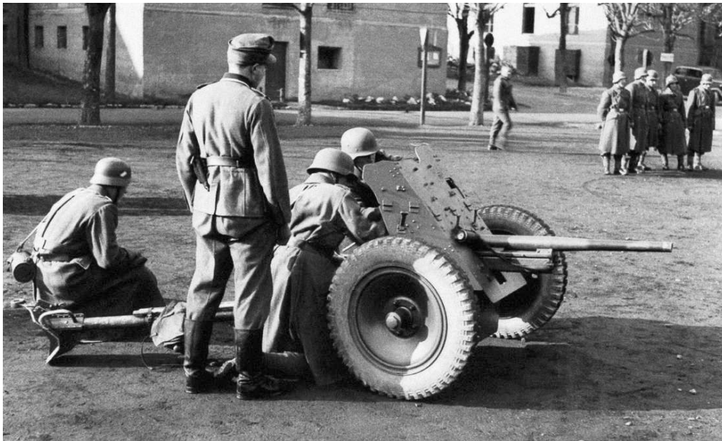
Тренировка расчета 37-мм противотанковой пушки Рак 35/36 из состава 6-й горно-стрелковой дивизии. Лето 1940 года. Хорошо виден надульник (чехол для закрытия ствола от попадания в него посторонних предметов), закрепленный на щите (РГАКФД).
