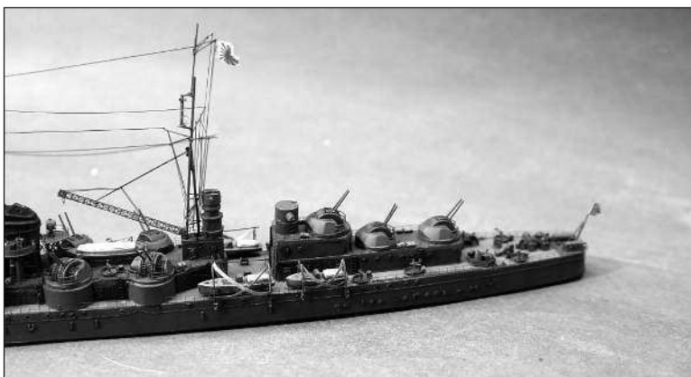
Так мог бы выглядеть японский крейсер ПВО специальной постройки стандартным водоизмещением около 6500 т с 12 спаренными универсальными АУ. Модель современного автора в масштабе 1:700
