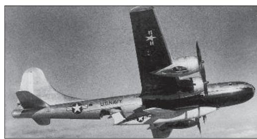
14 марта 1947 г. ВМС США получили четыре B-29-BW для выполнения поисково-спасательных операций на дальних расстояниях, их обозначили P2B-15. Один самолет (на снимке) модифицировали для испытаний ВМС высокоскоростного экспериментального D-558-II, который подвешивался под бомбардировщик и сбрасывался с него.
