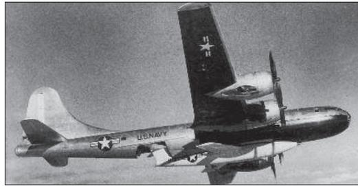
14 марта 1947 г. ВМС США получили четыре B-29-BW для выполнения поисково-спасательных операций на дальних расстояниях, их обозначили P2B-15. Один самолет (на снимке) модифицировали для испытаний ВМС высокоскоростного экспериментального D-558-II, который подвешивался под бомбардировщик и сбрасывался с него.
