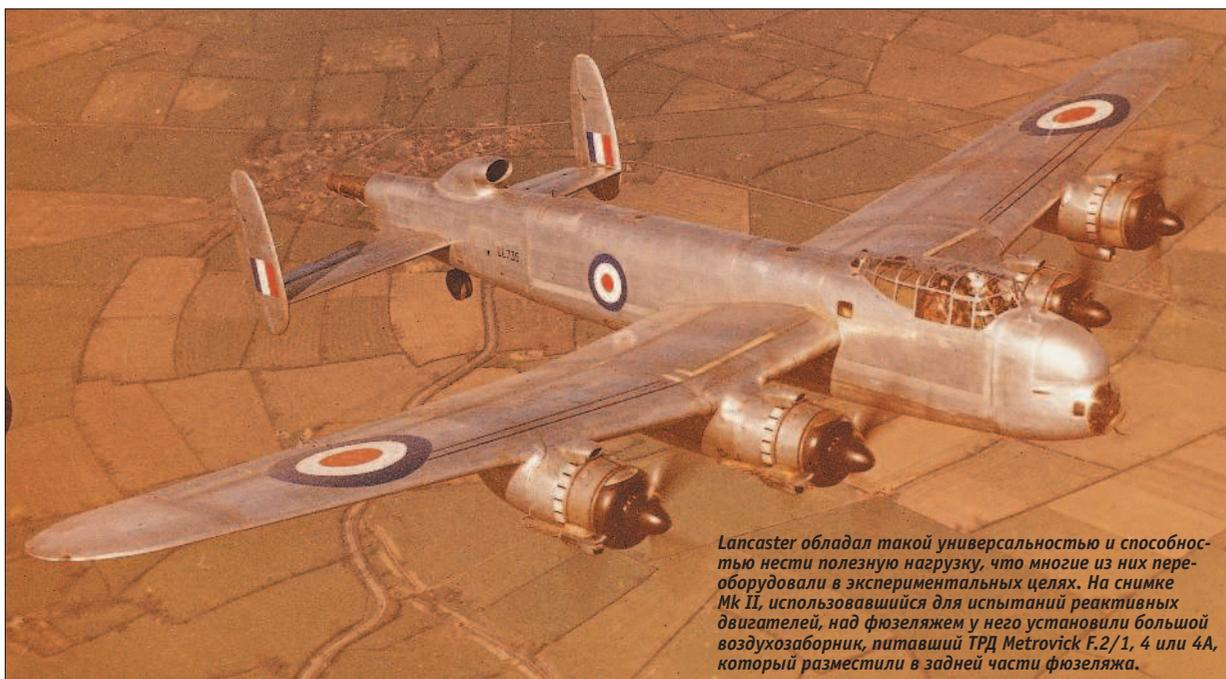
*Lancaster обладал такой универсальностью и способностью нести полезную нагрузку, что многие из них переоборудовали в экспериментальных целях. На снимке Mk II, использовавшийся для испытаний реактивных двигателей, над фюзеляжем у него установили большой воздухозаборник, питавший ТРД Metrovick F.2/1, 4 или 4A, который разместили в задней части фюзеляжа.*
