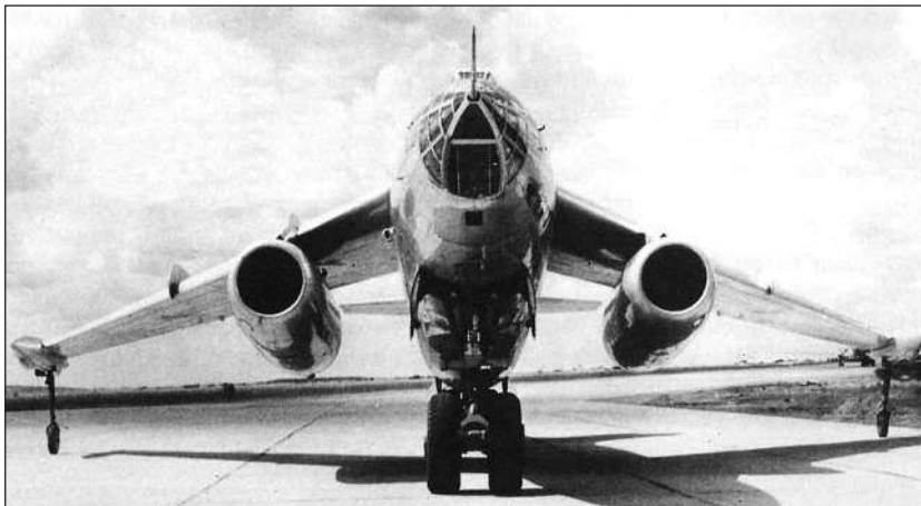
Для достижения сверхзвуковой скорости полета Ил-54 оснащался тонким крылом со стреловидностью 55° и двумя ТРД АЛ-7Ф на пилонах
