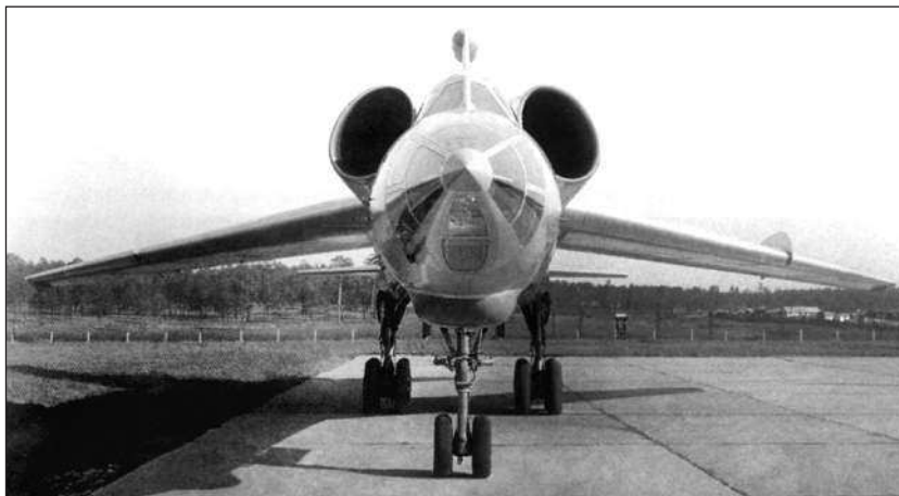
Одной из особенностей самолета «98» была своеобразная схема шасси с уборкой основных опор в фюзеляж с непривычно узкой колеей
