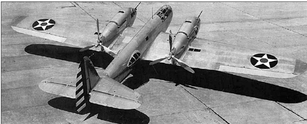
**Фирма «Белл» также попробовала свои силы в создании двухмоторных истребителей. На фото — пятиместный самолет XFM-1 «Аэрокуда», вооруженный двумя подвижными 37-мм пушками**
