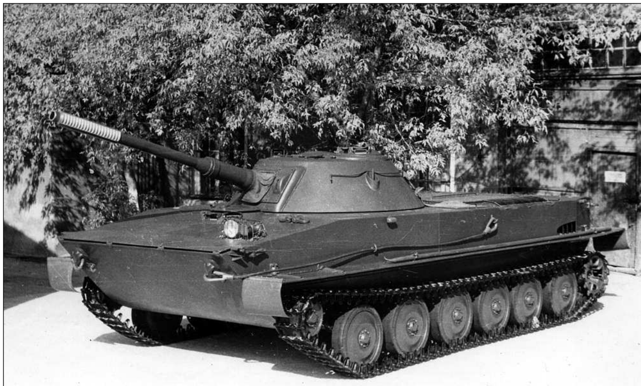
Танк ПТ-76 обр. 1952 г. Обращают на себя внимание гладкие штампованные опорные катки и фара ФГ-10 в паре с сигналом на верхнем лобовом листе корпуса (внизу и на с. 10 вверху)
