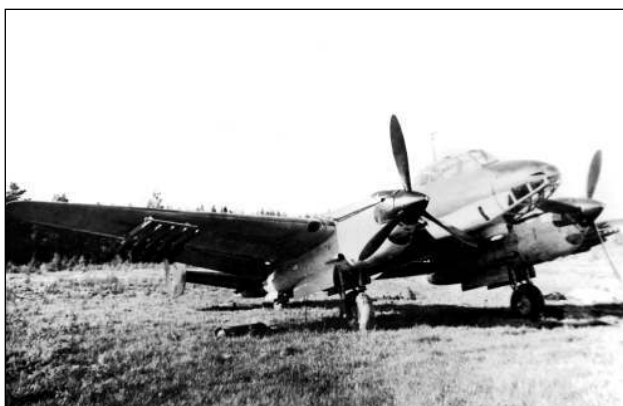
Осенью 1941 г. под крыло «пешки» в экспериментальном порядке подвесили две батареи реактивных орудий РО-132. В этом случае залп Пе-2 по мощи был соизмерим с залпом легкого крейсера. Однако слабость бронирования не позволила применять самолет для штурмовки
