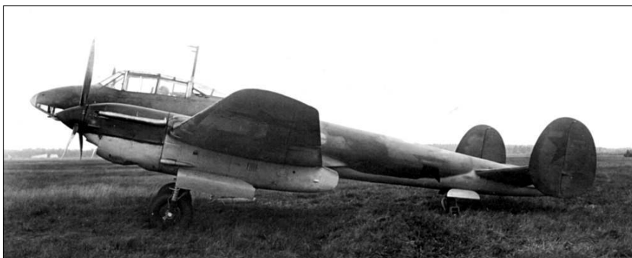
Тяжелый истребитель Пе-3, созданный путем внесения незначительных изменений в конструкцию Пе-2, внешне отличался дополнительным крупнокалиберным пулеметом, ствол которого проходил через нижнюю панель остекления, а также отсутствием люкового пулемета и овальных иллюминаторов в хвостовой части фюзеляжа (нужда в них отпала, так как самолет стал двухместным)
