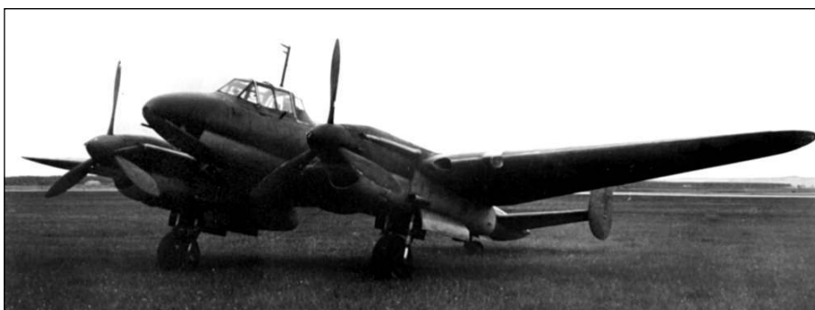
Тяжелый истребитель Пе-3бис выпускался малой серией весной и летом 1942 г. на иркутском заводе № 39. Он получил пушку ШВАК, смонтированную в носовой части фюзеляжа, а также штурманскую экранированную турель ВУБ-3 с пулеметом УБК. В хвостовом коке монтировали «пугач» — неуправляемый пулемет ШКАС, стрелявший назад
