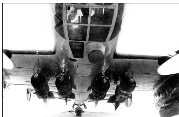
При использовании в качестве пикирующего бомбардировщика Пе-2 мог нести на внешней подвеске до четырех бомб ФАБ-250 общей массой 1000 кг. Хорошие условия обзора вперед-вниз обеспечивались обширным остеклением носовой части фюзеляжа
