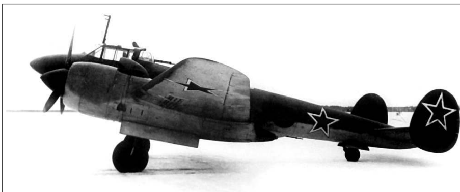
Серийный самолет Пе-2 с мощными моторами воздушного охлаждения М-82Ф. Вопреки ожиданиям, самолет не получил широкого распространения из-за недостаточной надежности винтомоторной установки и слишком большого расхода топлива, серьезно ограничившего радиус действия машины. К тому же было решено использовать эти моторы для бомбардировщиков и разведчиков Ту-2
