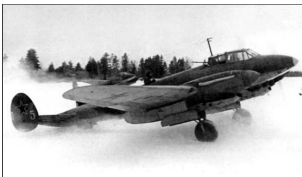
Для повышения обороноспособности самолета от атак истребителей сверху-сзади с весны 1942 г. ШКАС на турели штурмана заменили крупнокалиберным пулеметом БТ. Неофициально этот вариант машины называли Пе-2 ФТ («фронт требует»)
