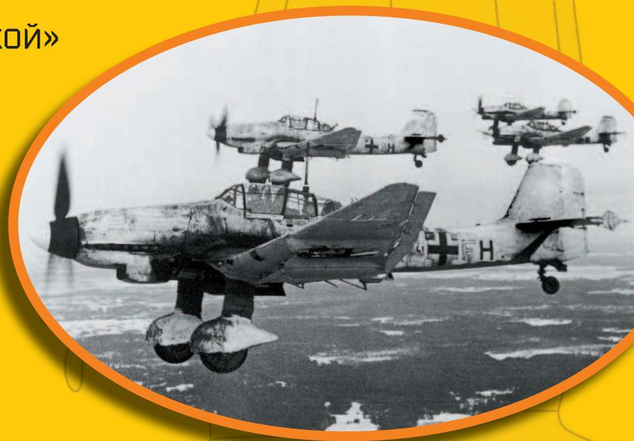
пикировать с большой точностью, ведя бомбометание и стрельбу из пулеметов. Скорость — до 390 км в час, дальность полета — 500 км. Вооружение — три пулемета, одна бомба весом 250 кг и четыре по 50 кг (подвешивались попарно под каждым крылом).
