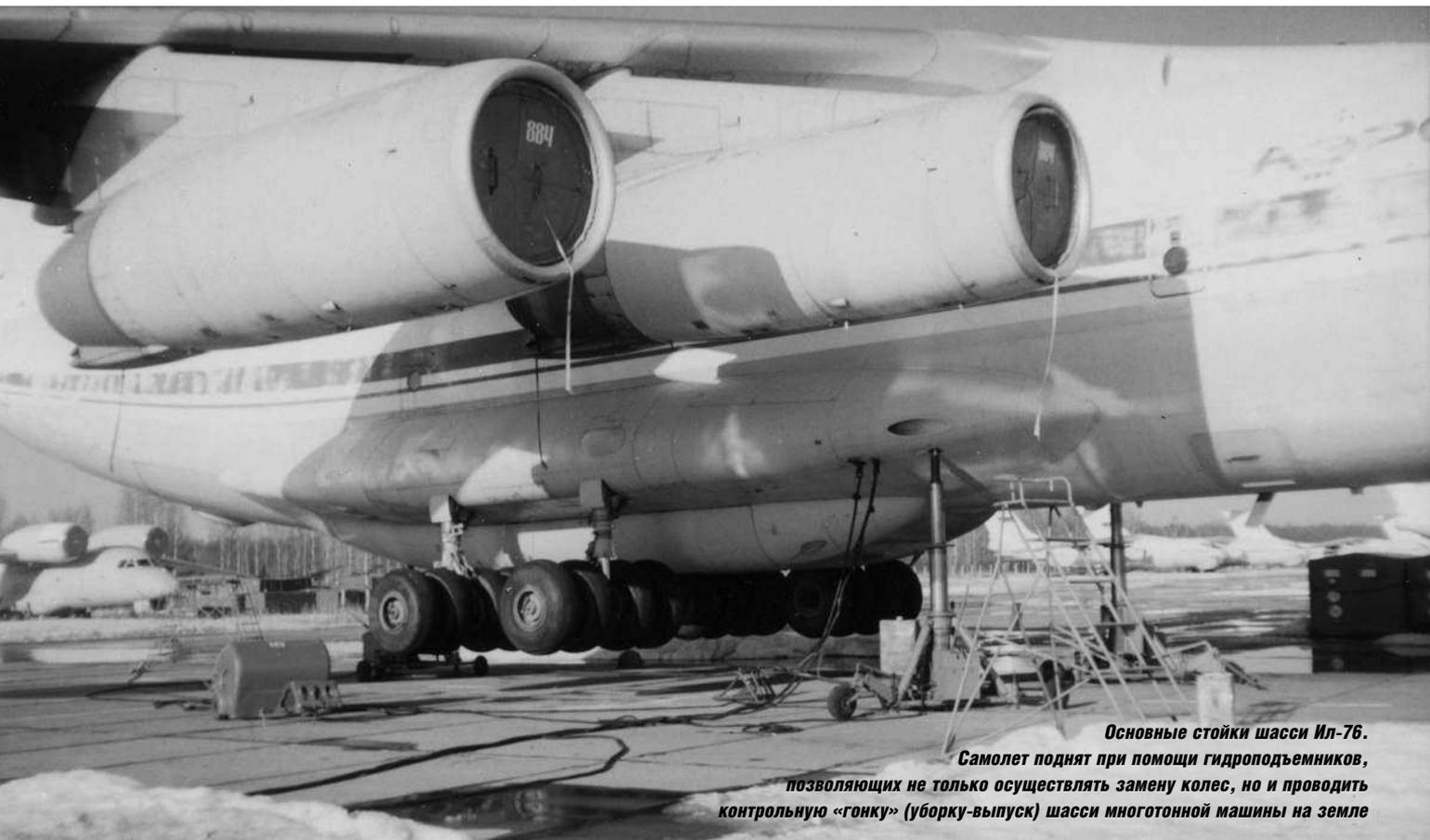
**Основные стойки шасси Ил-76. Самолет поднят при помощи гидropодъемников, позволяющих не только осуществлять замену колес, но и проводить контрольную «гонку» (уборку-выпуск) шасси многотонной машины на земле**
