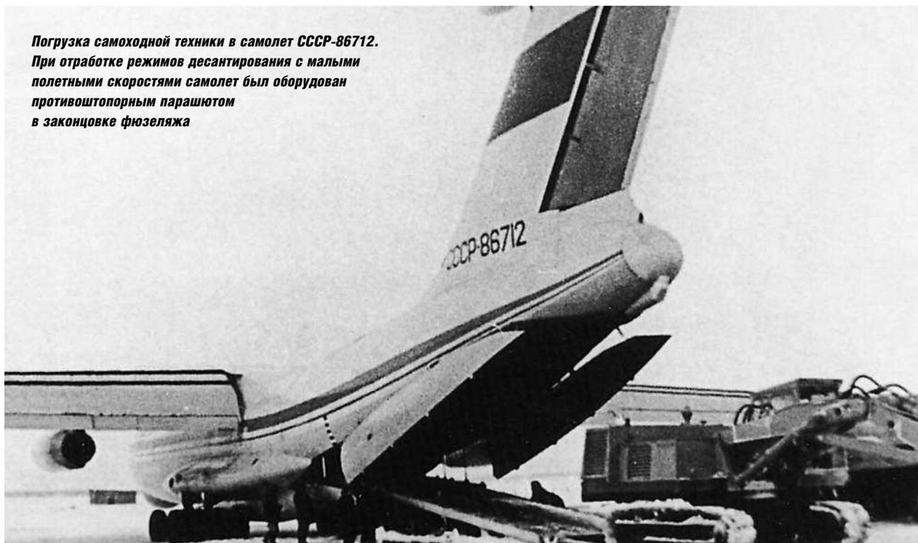
*Погрузка самоходной техники в самолет СССР-86712. При отработке режимов десантирования с малыми полетными скоростями самолет был оборудован противошторным парашютом в законцовке фюзеляжа*
