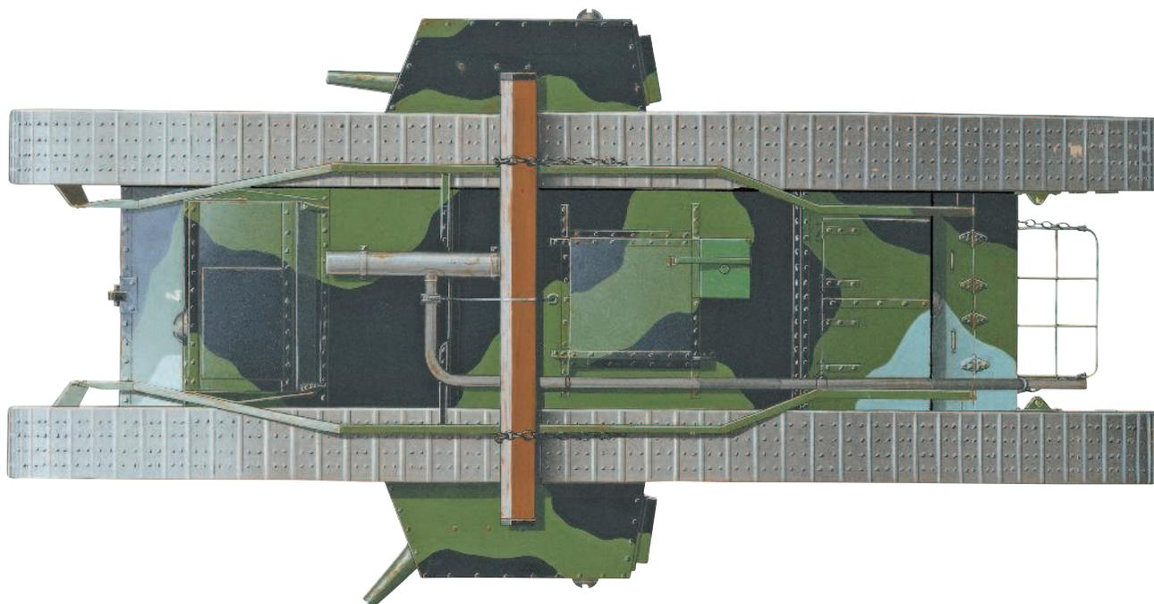
Хотя и с ограниченным сектором обстрела, пара установленных в спонсонах 6-фунтовых орудий обеспечивали значительную огневую мощь, в то время как улучшенная конструкция корпуса позволяла двигаться по неровной местности поля боя.
