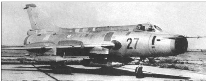
Самолет Су-17, доработанный для испытаний унифицированных контейнеров мелких грузов КМГ-У
