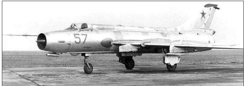
Су-17 (№ 8601) с бескаркасным козырьком фонаря на аэродроме НИИ ВВС. По низу фюзеляжа самолета виден обтекатель трубопровода для обдува лобового стекла, под носом – гондola с фотоконтрольным прибором С13-100 для съемки пусков ракет
