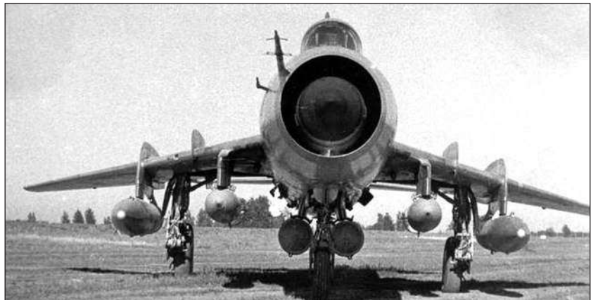
Истребитель-бомбардировщик Су-17 (№ 8602) во время испытаний базирования на грунтовом аэродроме. Самолет несет два 600-литровых ПТБ, РБК под фюзеляжем и ФАБ-500 М-62 под крылом
