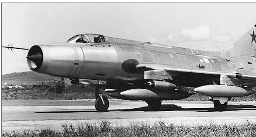
Истребитель-бомбардировщик Су-17 первых серий на заводском аэродроме. Самолет оснащен четырьмя ПТБ-600 и парой блоков УБ-16-57УМП
