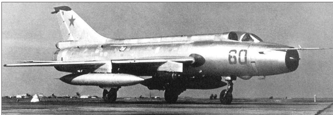
Второй экземпляр истребителя-бомбардировщика Су-17 (С32-2 № 8502) во время испытаний в Ахтубинске. Под носовой частью самолета видна антенна телеметрической аппаратуры
