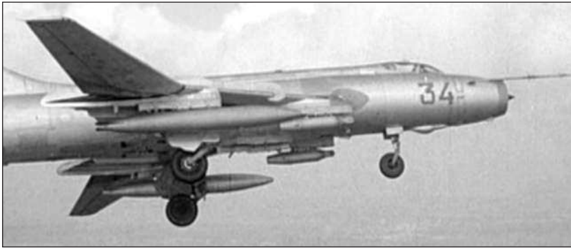
Самолет несет два ПТБ-600 под фюзеляжем и пару ракетных блоков УБ-16-57УМП под крылом
