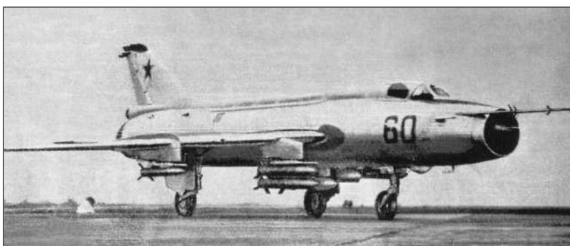
На фото из инструкции летчику – самолет С32-2 с шестью крупнокалиберными НАР С-24 на пусковых устройствах ПУ-12-40УД
