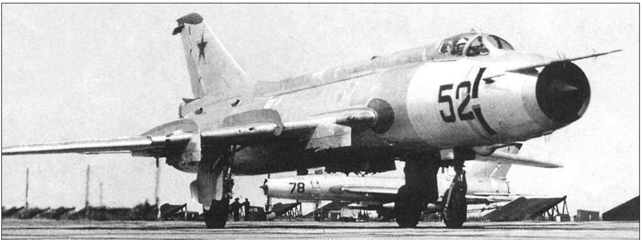
Для улучшения устойчивости на Су-17 с № 9221 на неподвижной части крыла сверху устанавливалась третья пара аэродинамических перегородок
