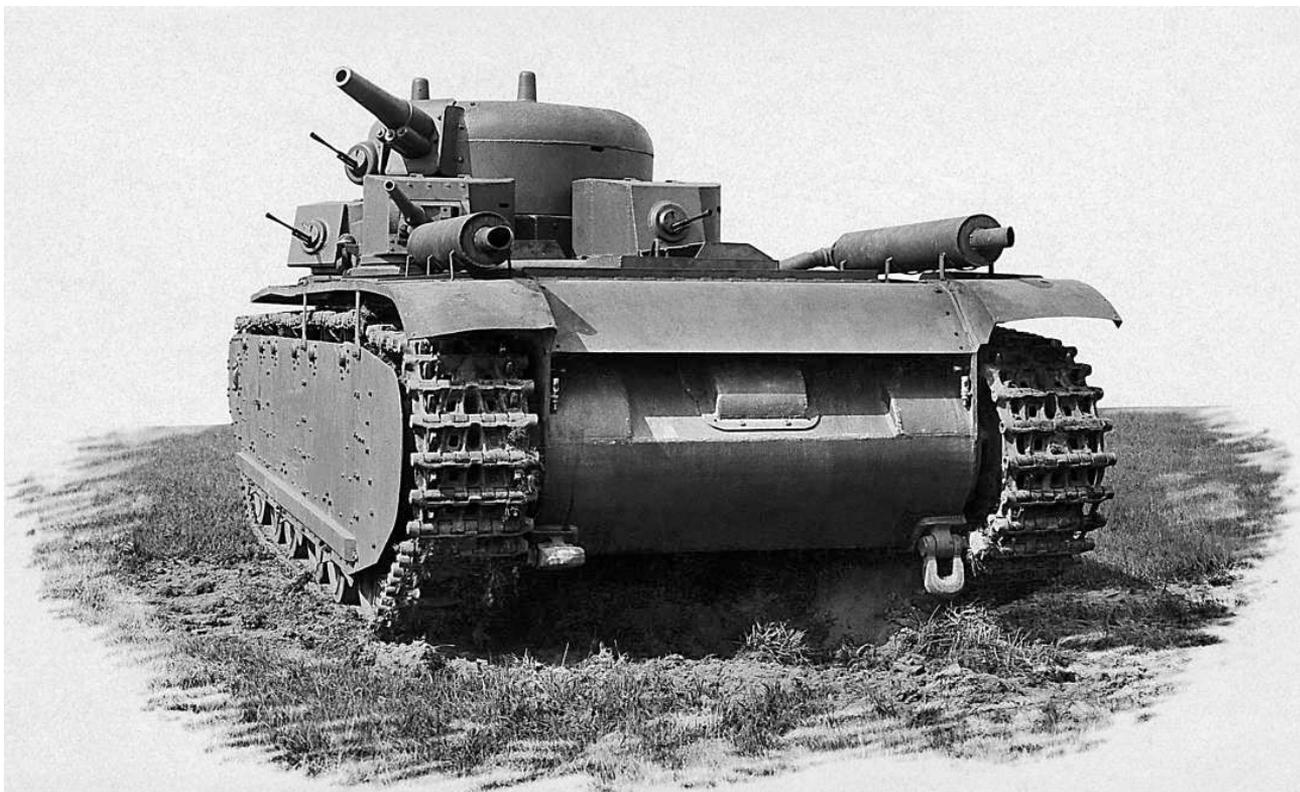
*Танк Т-35-1, вид сзади и слева – хорошо видна конструкция глушителей и экрана подвески (АСКМ).*
