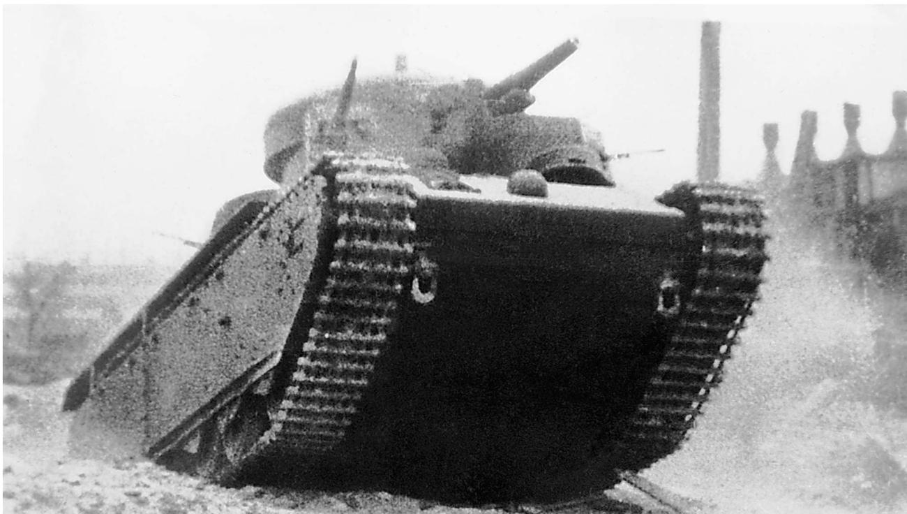
*Танк Т-35-1 преодолевает вертикальную стенку высотой 1 метр (АСКМ).*
