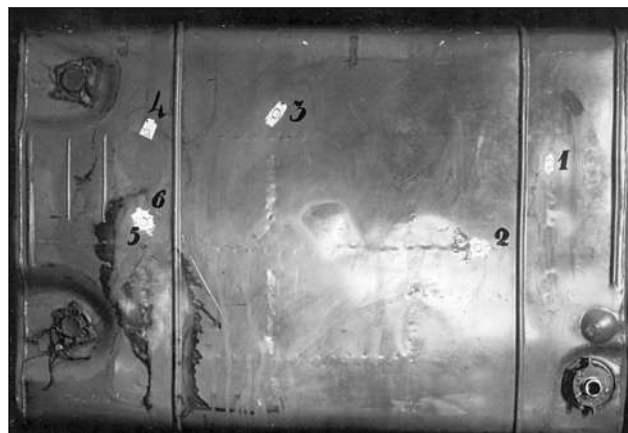
Места протекания бензобака машины Н, обозначенные цифрами 1рб. 31.05.1941 г. Архив ОКБ
