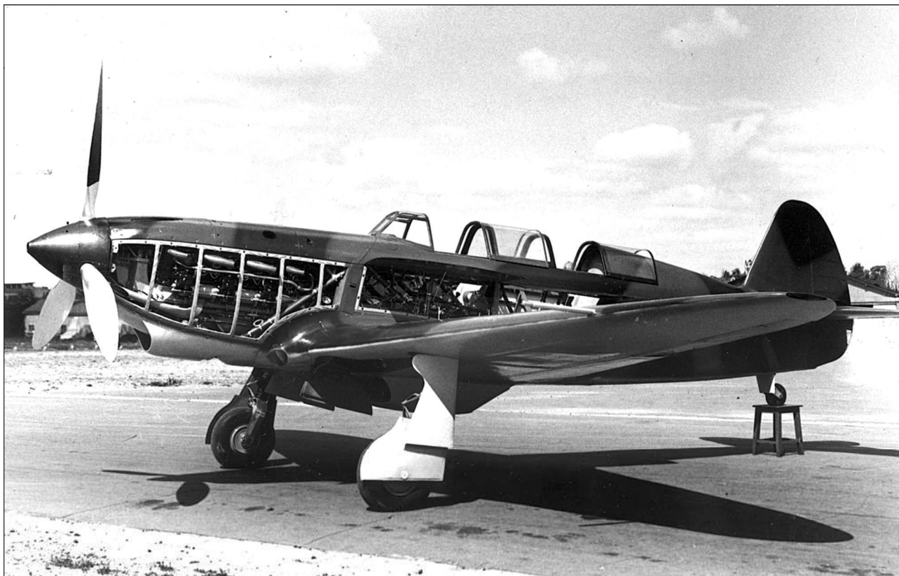
Нивелировка УТИ-26-I перед передачей на государственные испытания. Архив ОКБ
