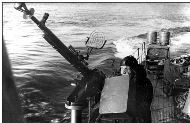
12,7-мм пулемет ДШК с увеличенной лентой на 100 патронов
