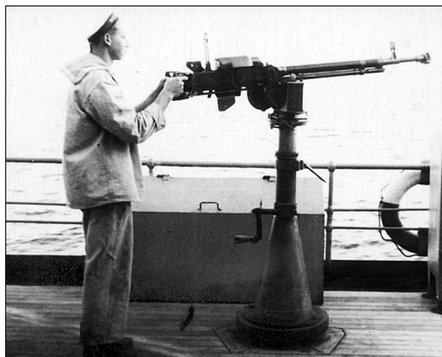
12,7-мм пулемет ДШК на тумбовом лафете
