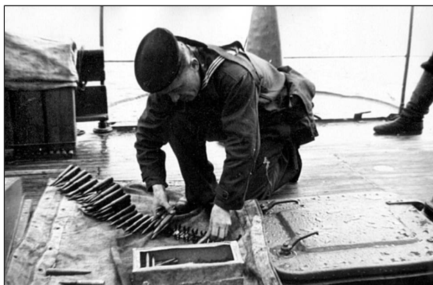
Снаряжение ленты пулемета ДШК
