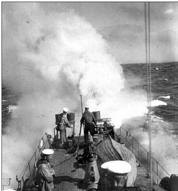
Вверху: дымовые шашки МДШ на одном из катеров типа МО Северного флота. Хорошо видны бомбосбрасыватели с ГБ ББ-1 Внизу: постановка дымовой завесы катером типа МО
