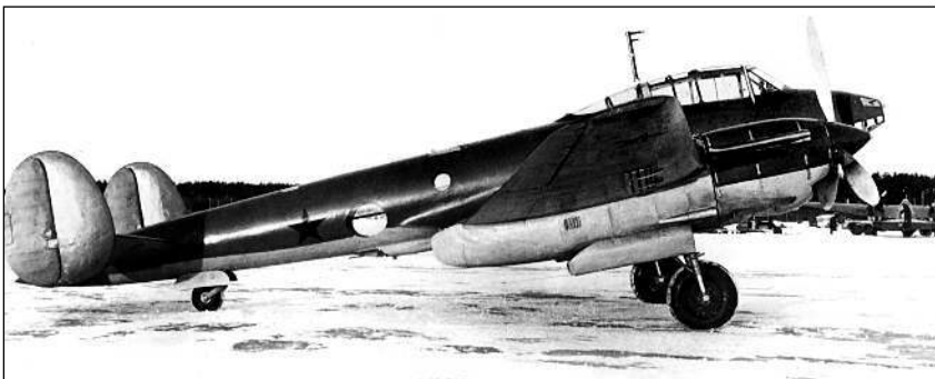
Первый серийный самолет Пе-2, построенный на московском заводе № 39. Остекление кабины штурмана включает опускающуюся часть фонаря, так называемую «черепаху»
