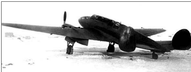
Скоростной пикирующий бомбардировщик СПБ с моторами М-105 был создан на базе ВИТ-2
