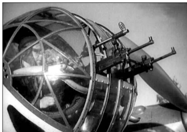
Носовая оборонительная огневая установка самолета СБ с двумя пулеметами ШКАС. Через отверстия для стволов в кабину пилота и штурмана отчаянно задувало, что было особенно неприятно зимой
