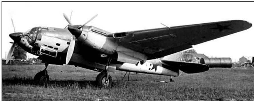
Пикирующий бомбардировщик Ар-2 с моторами М-105 был создан на основе СБ-РК. Площадь крыла была уменьшена, под консолями появились тормозные решетки, иными стали носовая часть фюзеляжа и киль
