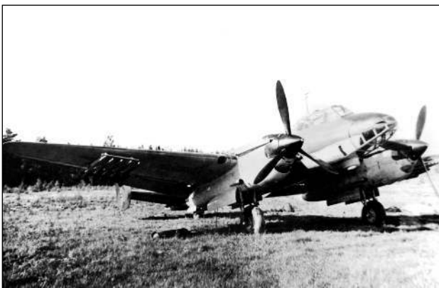
Осенью 1941 г. под крыло «пешки» в экспериментальном порядке подвесили две батареи реактивных орудий РО-132. В этом случае залп Пе-2 по мощи был соизмерим с залпом легкого крейсера. Однако слабость бронирования не позволила применять самолет для штурмовки
