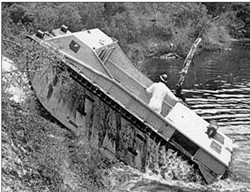
«Аллигатор», доработанный согласно пожеланиям морской пехоты, демонстрирует способность выхода на сравнительно крутой берег.
