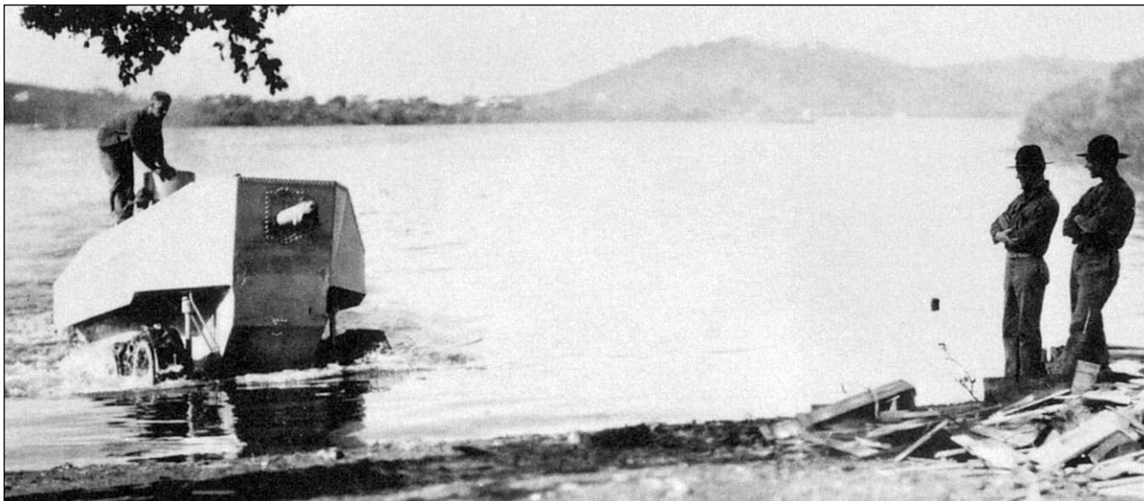
Испытания Корпусом морской пехоты США плавающего колесно-гусеничного танка (самоходной артиллерийской установки) М1923 Уолтера Кристи во время зимних маневров 1924 г. на о. Кулебра
