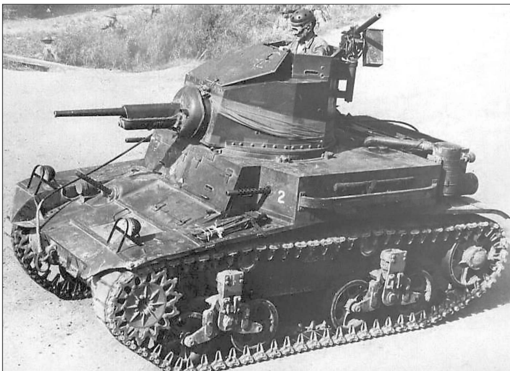
Легкий танк M2A4 из состава 2-й танковой дивизии армии США. 1941 год. Эта машина оснащена дизельным двигателем Guiberson T-1020
