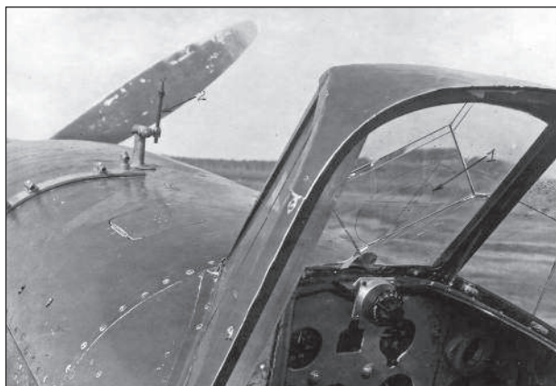
Размещение прицела ВВ-1 на самолете Ил-2:
