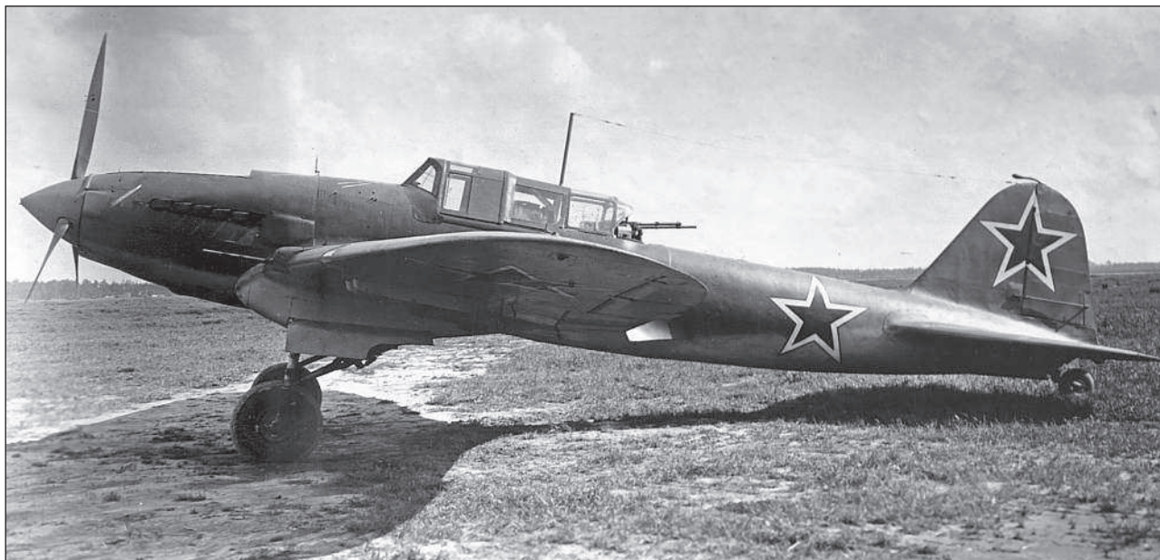
Двухместный Ил-2 зав. № 1882702 производства завода № 18 на контрольных испытаниях в НИИ ВВС, июль 1944 г. На бронекорпусе хорошо видна разметка для бомбометания с горизонтального полета и визирные штыри.
