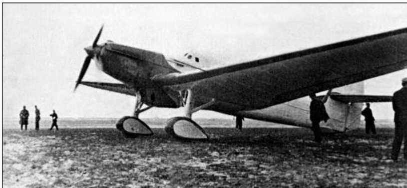
Стратосферный самолет БОК-1, аэродинамический расчет которого выполнил С.А. Лавочкин
