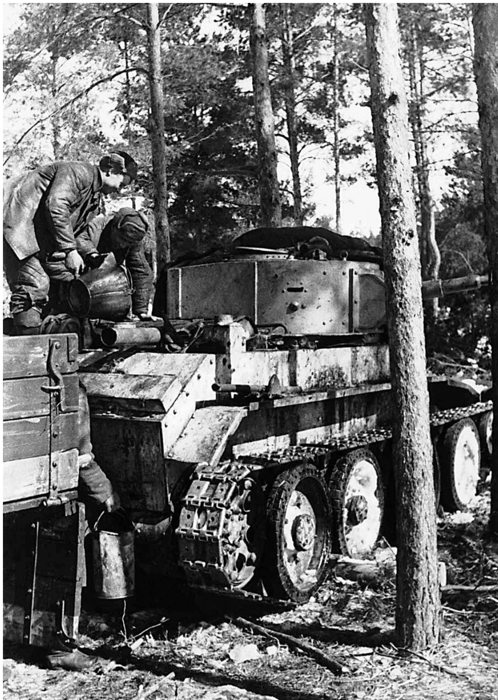
Заправка горючим (из ведра вручную) танка БТ-7 (с цилиндрической башней и зенитной турелью). Юго-Западный фронт, апрель 1942 года. Скорее всего, машина из состава 10-й танковой бригады (РГАКФД).
