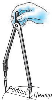
**Рис. 16.** Проведение окружности циркулем
