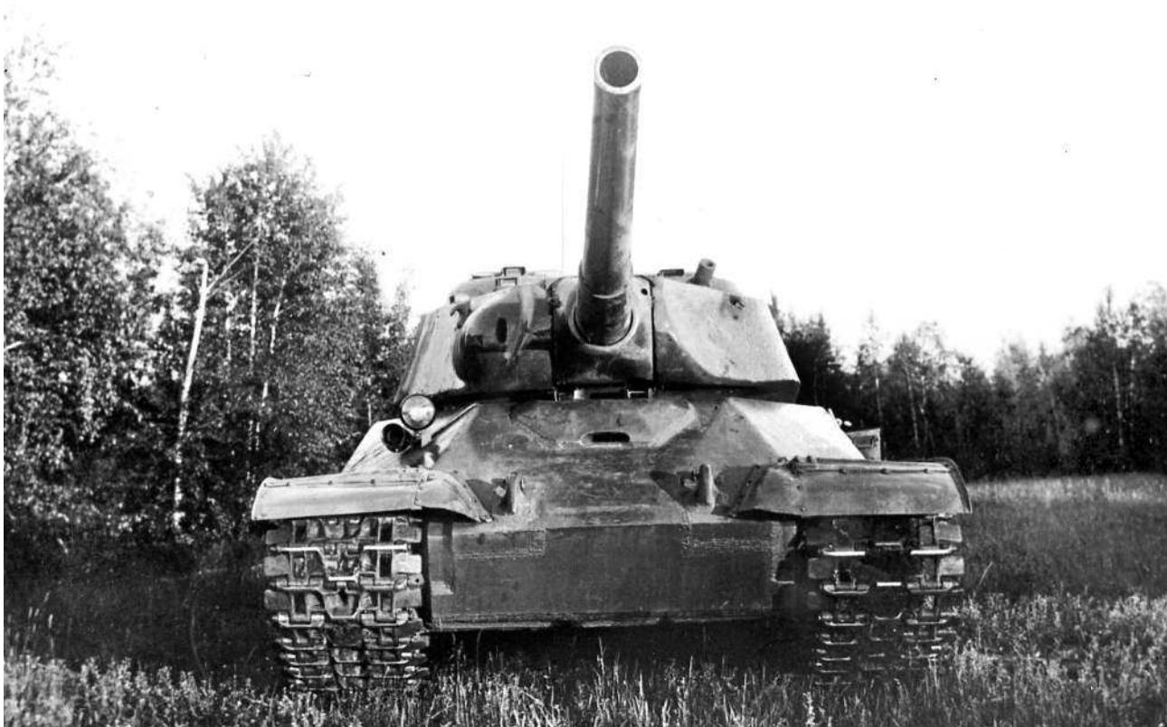
Танк «объект 701» № 1 перед началом испытаний, вид спереди. Лето 1944 года. Обратите внимание на шарообразную бронировку прицела орудия (РГАЭ).
